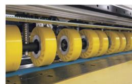
一列の資材抑えローラーで高速の稼働でも高精度で安定な加工を行います。
