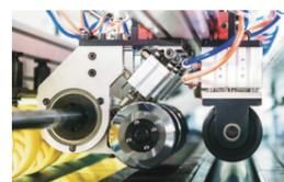
サーボモーターで制御された4本のスリッターナイフを備えています。縦方向の加工にはナイフコームを使用し摩耗を防ぎます。
