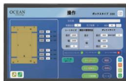
シンプルなタッチパネル式のインターフェイスを採用。形状選択、及び寸法入力を行うだけで、60秒ほどで自動的に調整が完了します。
