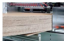
連続給紙に対応。シートエッジを読み込み、反りに対しても安定した供給を実現します。
