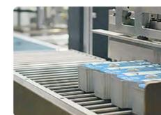
ボールスクリューとLMガイドを採用する事で、高精度な位置決めが可能になり、積み込み位置のエラーを回避します。
