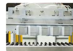
高精度な位置決めと安定した動作を実現させる為に、サーボモーターを採用しております。
