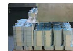
空圧システムにより、一定量の製品を正確に、且つ綺麗にパレタイズします。
