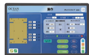
タッチパネル式のインターフェース 操作简单、形状選択及び寸法入力を行うだけで、6秒ほどで調整完了
