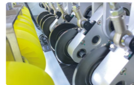
サーボモーター制御加工システム 6本のスリッターナイフや野線を備えて高精度の加工。またナイフフォームを使用し摩耗を防止
