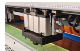
取手穴加工ユニット オプションで最大2個の木型を取り付け可能
