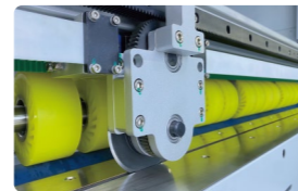
資材抑えローラーと横スリッター 高速の稼働でも高精度で安定した加工が可能
