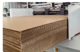
連続給紙に対応 シートエッジを読み込み、反りに対しても安定した供給を実現
