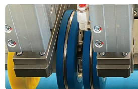
2種類の罫線仕様 標準で75mm罫線ユニットを搭載 またオプション30mm対応でより多くの形状加工が可能
