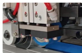
段潰し機能 厚みのある段ボールに対応の糊状段潰し機能
