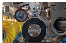
サーボモーター制御加工システム 4本のスリッターナイフや罫線を備えて高精度の加工。またナイフコームを使用し摩耗を防止
